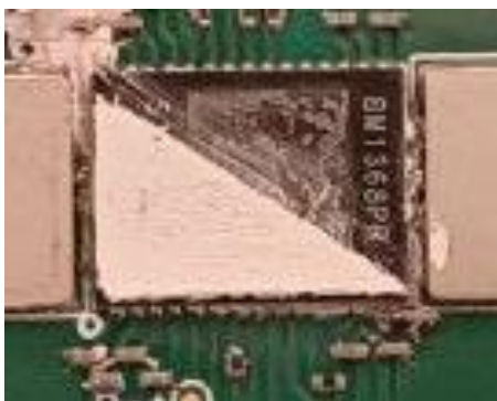
Obr. 11 Nanesení vlastní teplo vodivé pasty č.2 na polovinu čipu
