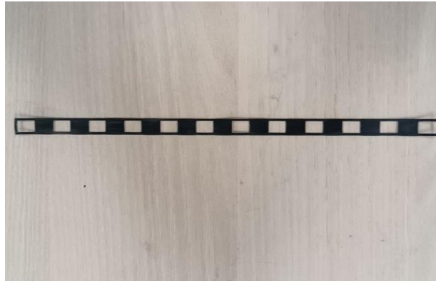
Obr. 9 Finální verze šablony na nanášení teplo vodivé pasty
